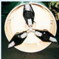
掘進時(オーバーカット)
