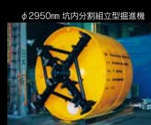
φ2950mm 坑内分割組立型掘進機
