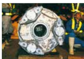
リターン回収掘進機カッタフェイス(引戻時)
