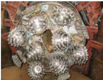
掘進機到達状況
