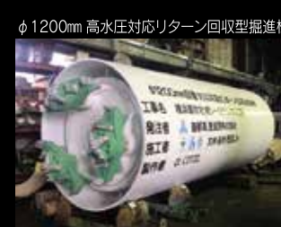
φ1200mm 高水圧対応リターン回収型掘進機
