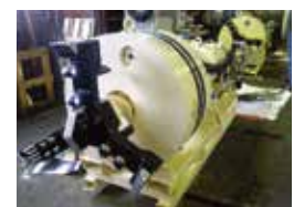
密閉型リターン回収掘進機 (一体型内部駆動装置)
