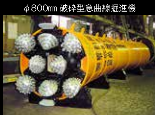
φ800mm 破碎型急曲線掘進機
