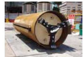
密閉型リターン回収掘進機 (外郭φ812mm残置鋼管挿入時)
