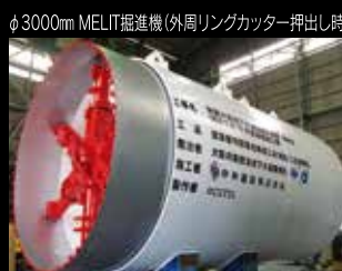
φ3000mm MELIT掘進機(外周リングカッター押し出し時)
