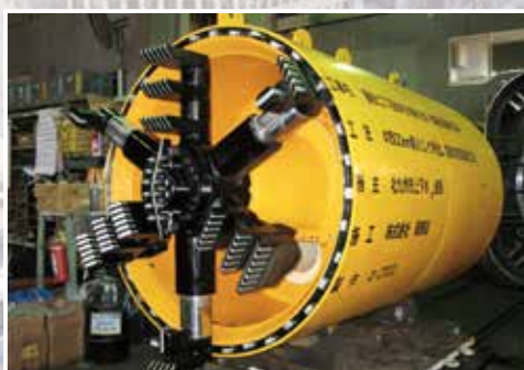
貫入リング対応型掘進機(通常掘進時)
