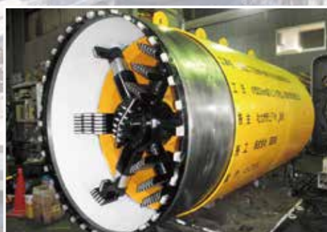
貫入リング対応型掘進機(切削リング伸長時)
