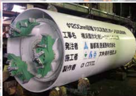
リターン回収(多軸型)対応掘進機
