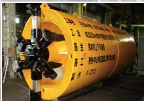
リターン回収(伸縮アーム型)対応掘進機
