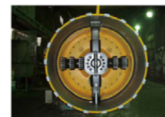
掘進機全景(切削時)
