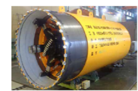
掘進機全景(切削時)
