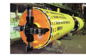
掘進機全景(推進時)
